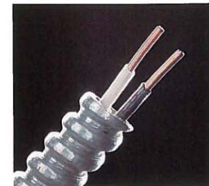
Le câble blindé BX possède une gaine métallique qui sert à la mise à la terre. Le courant court-circuité retourne au tableau de distribution par la gaine métallique.
