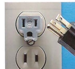
Les adaptateurs de prises permettent de brancher une fiche à trois branches dans une prise à deux fentes. Ils ne peuvent être utilisés qu'avec des prises mises à la terre, et le fil ou l'œillet de mise à la terre doit être attaché à la vis de la plaque.
